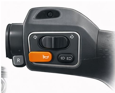
Punho esquerdo — setas, buzina, farol e marcha à ré (R)
